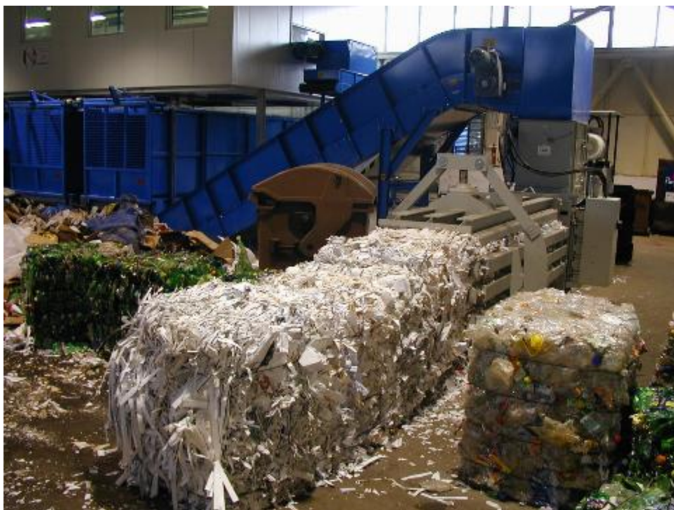
5.16-сурет. ТҚҚ қалдықтарын брикеттеуге арналған жабдықтың үлгісі [34]
