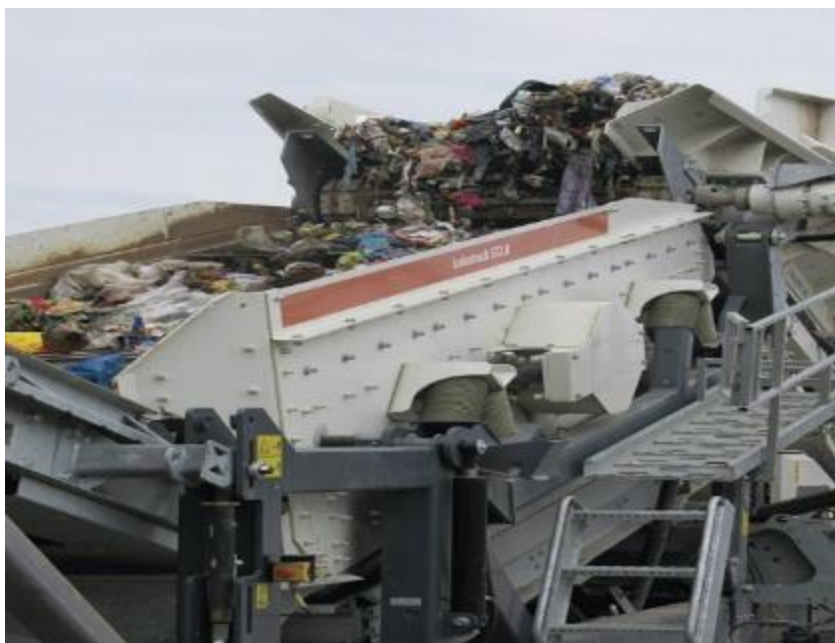
5.14-сурет. Ұсақталған қалдықтарды елеуішке тасымалдауға арналған жеткізуші конвейер [33]
