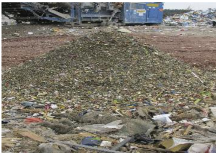
5.15-сурет. Ұсақталған ТҚҚ-ның сұрыпталған фракцияларының ең ұсағы [33]
