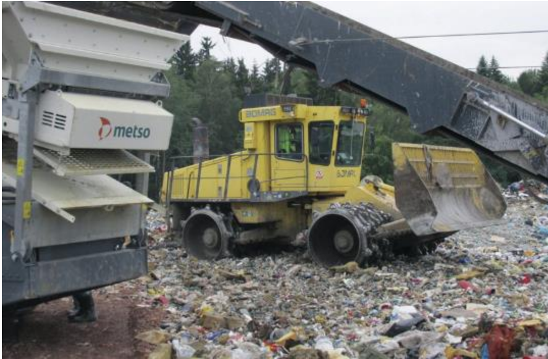
Рисунок 5.20. Компактор на полигоне ТБО, Чехия [28]
