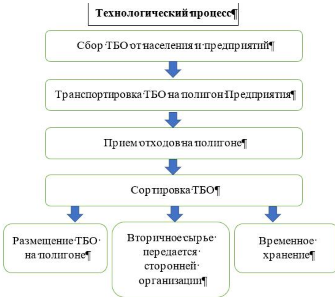
Рисунок 3.1. Технологическая схема полигона.
