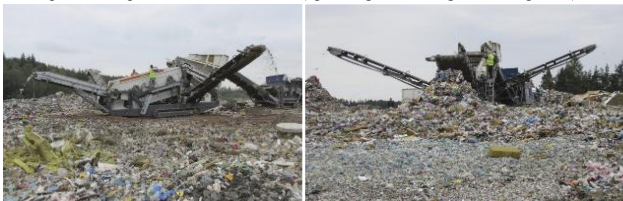
Рисунок 5.13. Грохот грубой очистки Lokotrack ST2.8 на полигоне ТБО. Слева горка с промежуточной фракцией, впереди – надфракция, справа – наименьшая подфракция[33].
