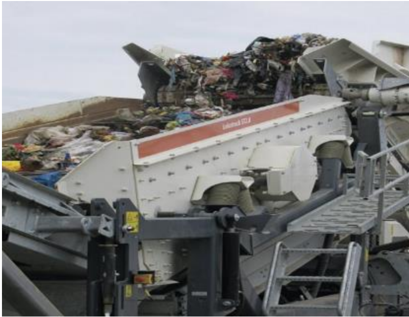
Рисунок 5.14. Подающий конвейер для транспортировки измельченных отходов на сита [33].
