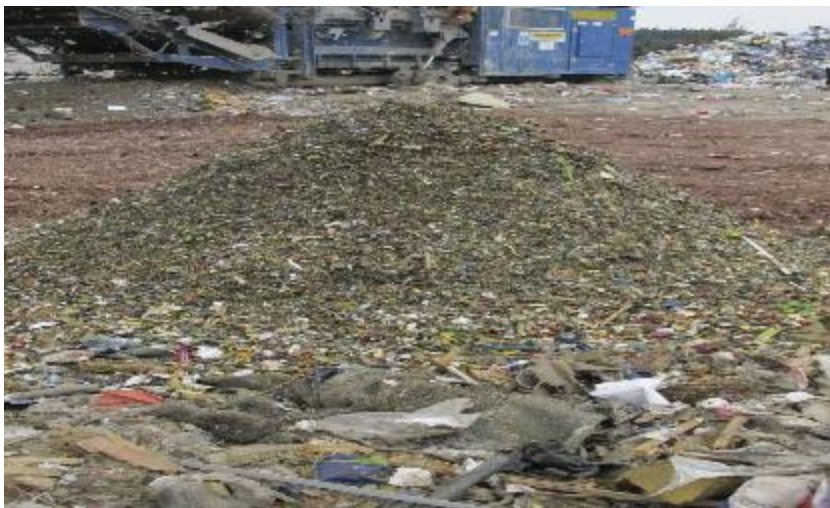
Рисунок 5.15. Наименьшая из отсортированных фракций дробления отходов ТБО [33].
