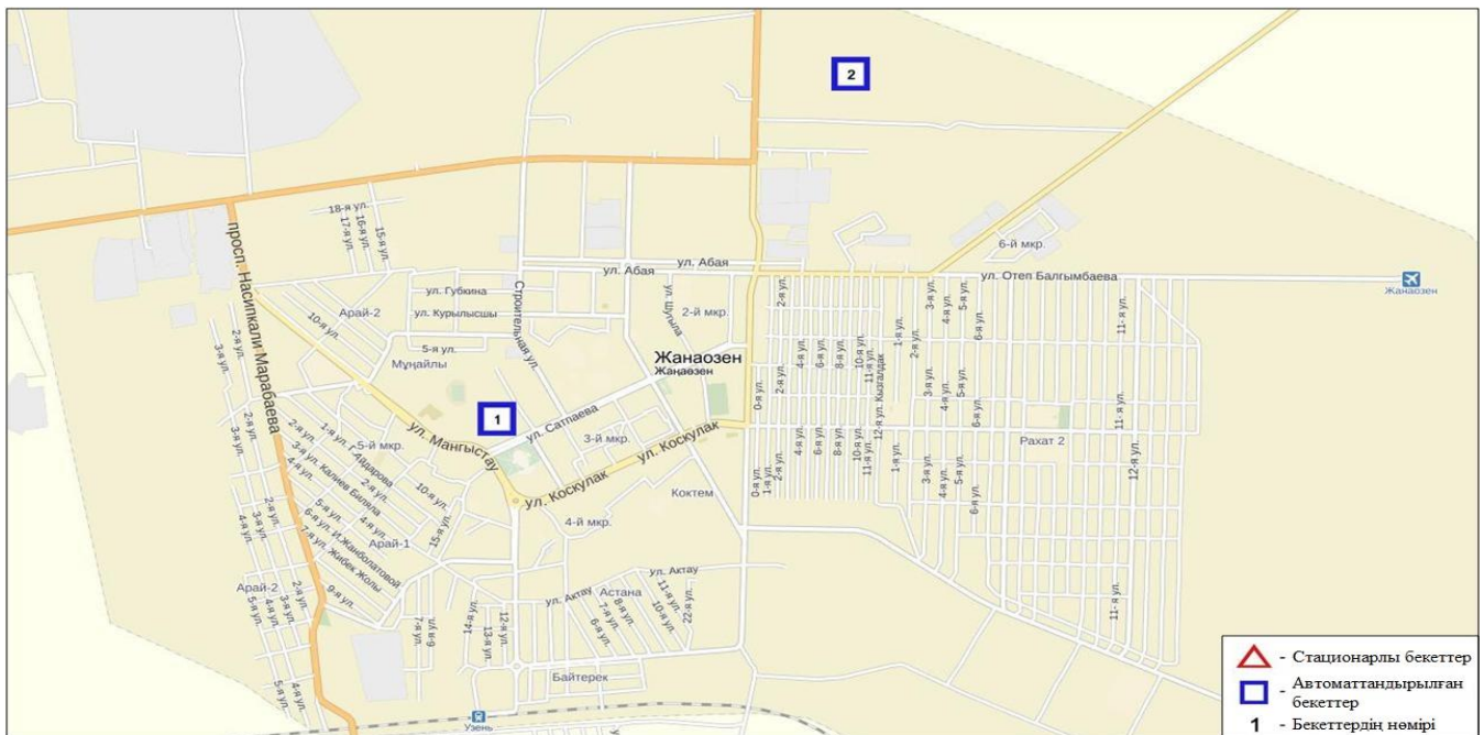
11.2-сурет. Жаңаөзен қаласының атмосфералық ауа ластануын бақылау стационарлық желісінің орналасу сызбасы
