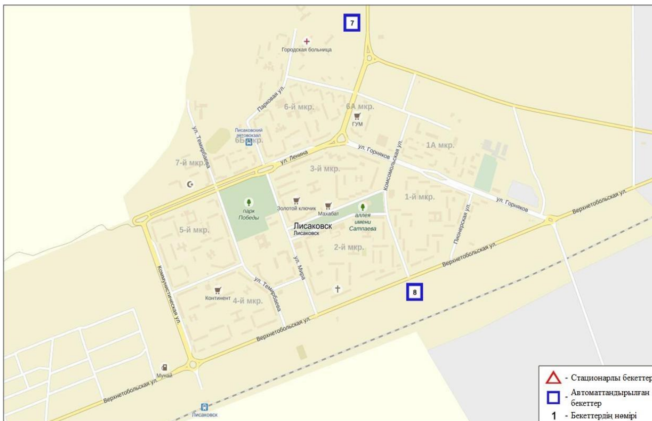
9.6-сурет. Лисаков қаласының атмосфералық ауа ластануын бақылау стационарлық желісінің орналасу сызбасы
