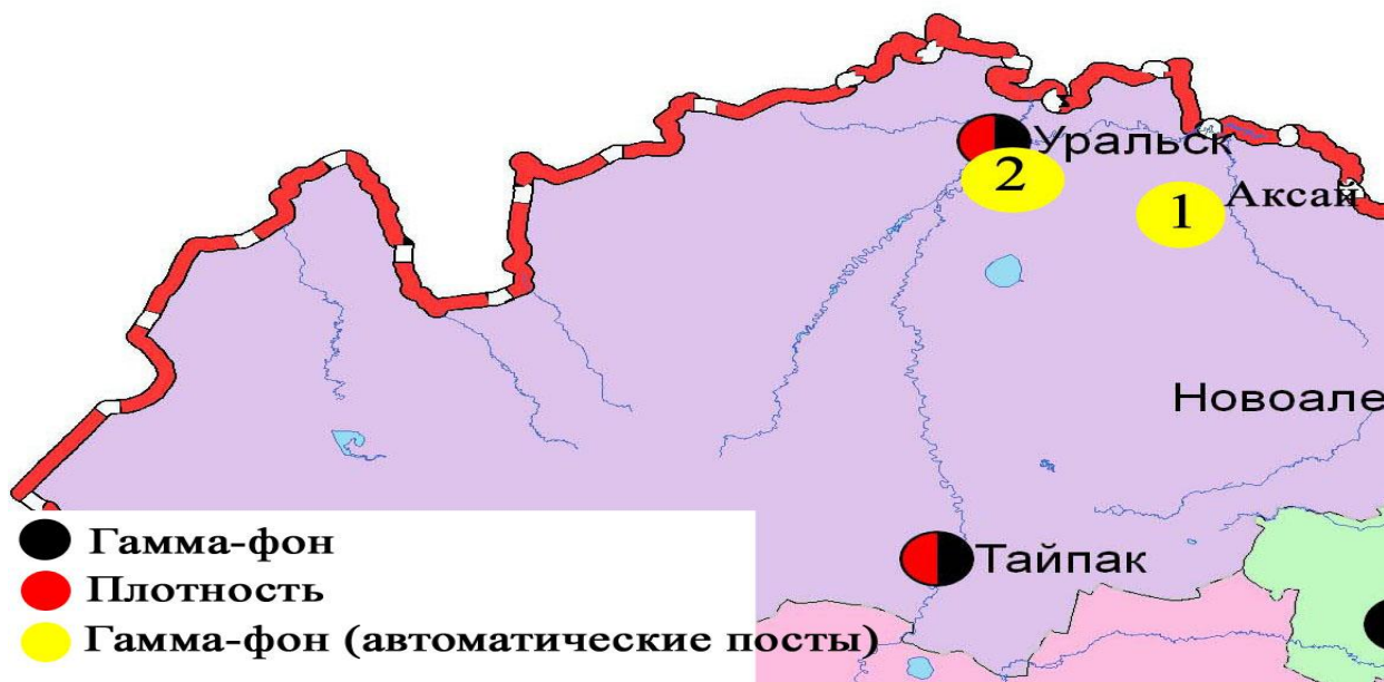
7.7 – сурет. Батыс Қазақстан облысының аумағындағы радиациялық гамма-фон мен радиоактивті түсулердің тығыздығын бақылау метеостансаларының орналасу сызбасы.
