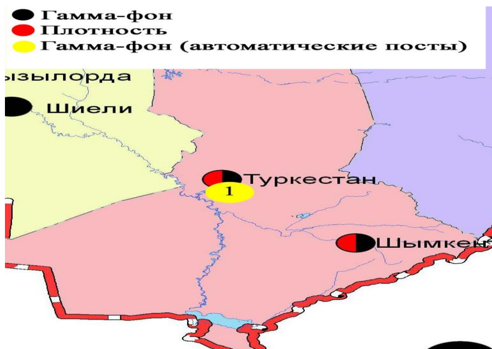
Рис. 14.3 Схема расположения метеостанций за наблюдением уровня радиационного гамма-фона и плотностью радиоактивных выпадений на территории Южно-Казахстанской области
