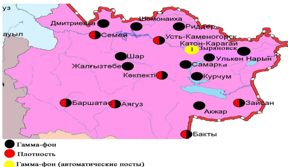
Рис. 5.6 Схема расположения метеостанций за наблюдением уровня радиационного гамма - фона и плотностью радиоактивных выпадений на территории Восточно - Казахстанской области
