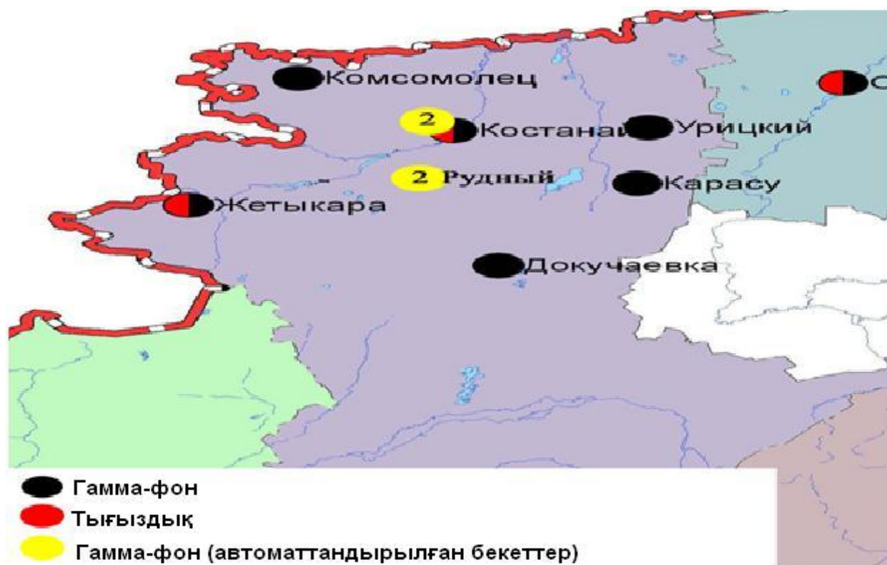
9.4 – сурет. Қостанай облысының аумағындағы радиациялық гамма-фон мен радиоактивті түсулердің тығыздығын бақылау метеостансаларының орналасу сызбасы.
