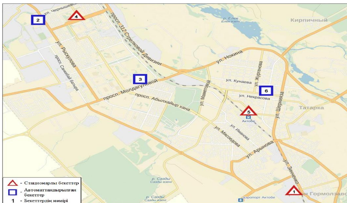
2.1-сурет. Ақтөбе қаласының атмосфералық ауа ластануын бақылау стационарлық желісінің орналасу сызбасы
