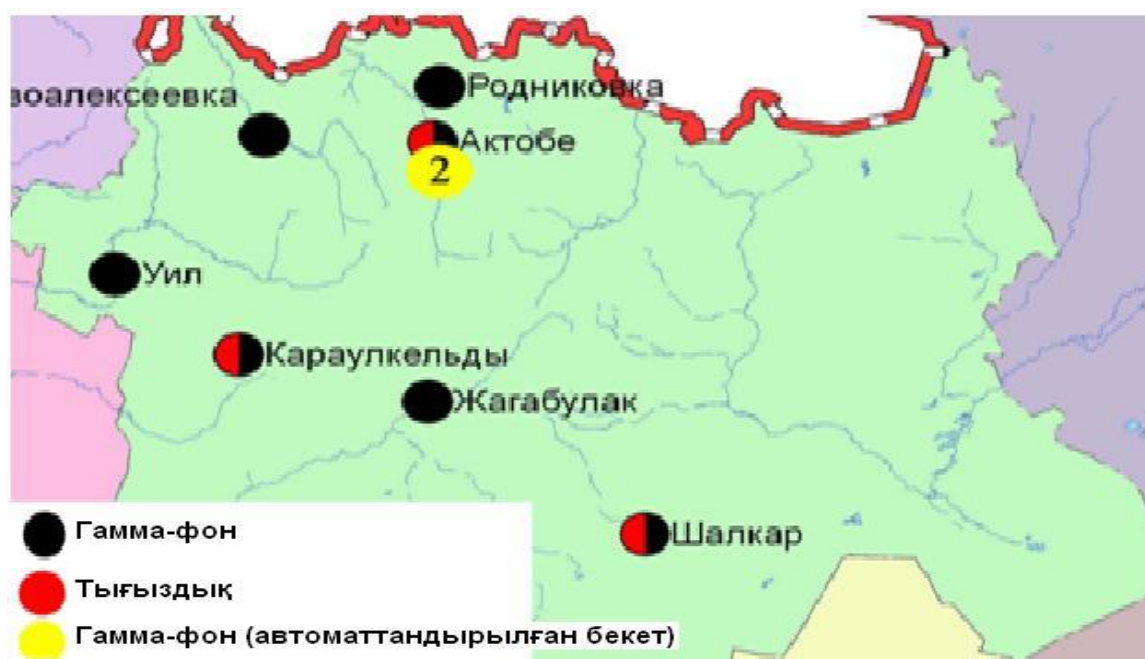
2.2 – сурет. Ақтөбе облысының аумағындағы радиациялық гамма-фон мен радиоактивті түсулердің тығыздығын бақылау метеостансаларының орналасу сызбасы
