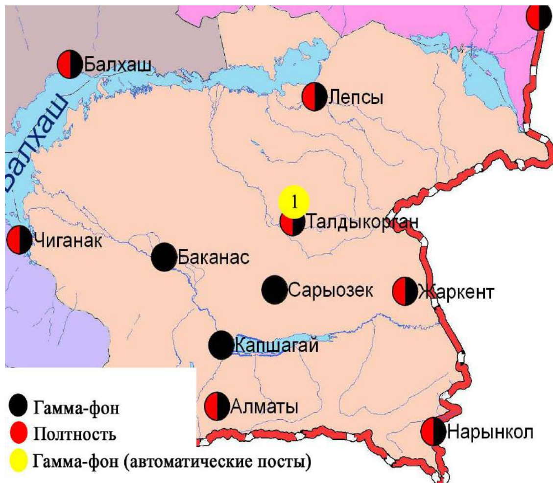
Рис. 3.6 Схема расположения метеостанций за наблюдением уровня радиационного гамма-фона и плотностью радиоактивных выпадений на территории Алматинской области
