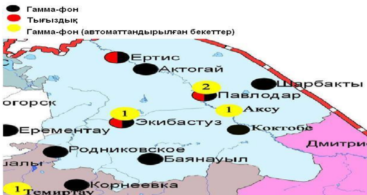
12.4-сурет. Павлодар облысының аумағындағы радиациялық гамма-фон мен радиоактивті түсулердің тығыздығын бақылау метеостансаларының орналасу сызбасы.
