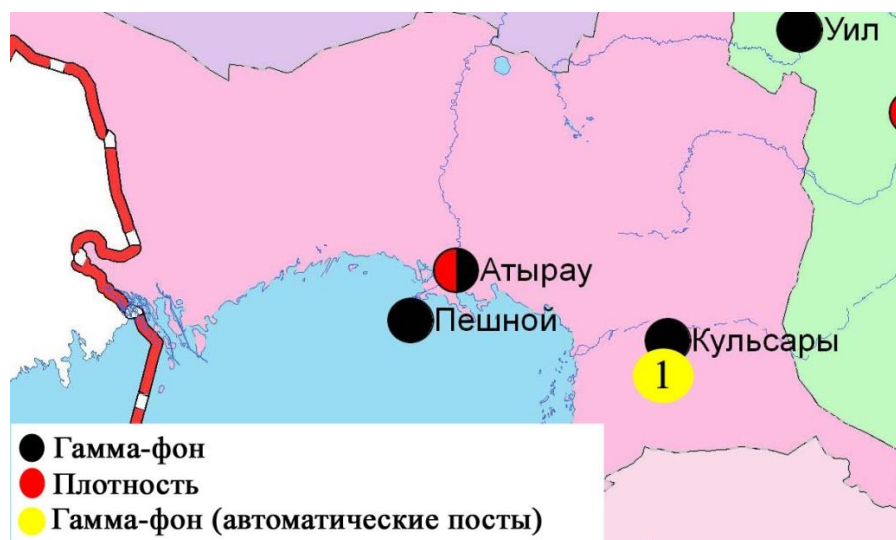
Рис. 4.3 Схема расположения метеостанций за наблюдением уровня радиационного гамма-фона и плотности радиоактивных выпадений на территории Атырауской области
