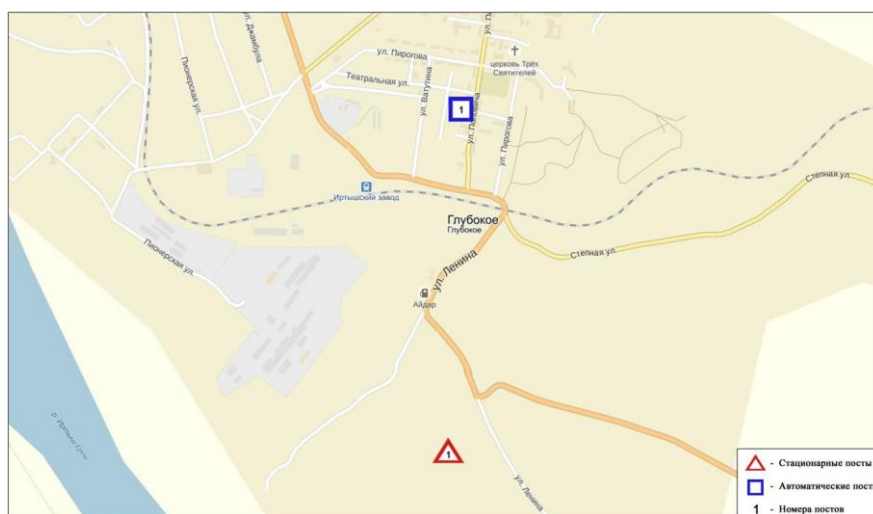
Рис. 5.5 Схема расположения стационарной сети наблюдений за загрязнением атмосферного воздуха в поселке Глубокое
