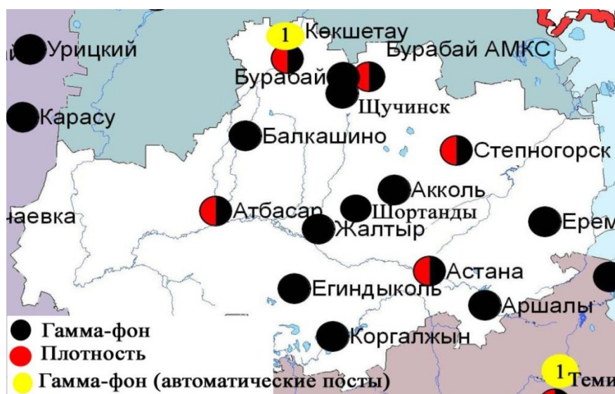
Рис. 1.6Схема расположения метеостанций за наблюдением уровня радиационного гамма-фона и плотности радиоактивных выпадений на территории Акмолинской области
