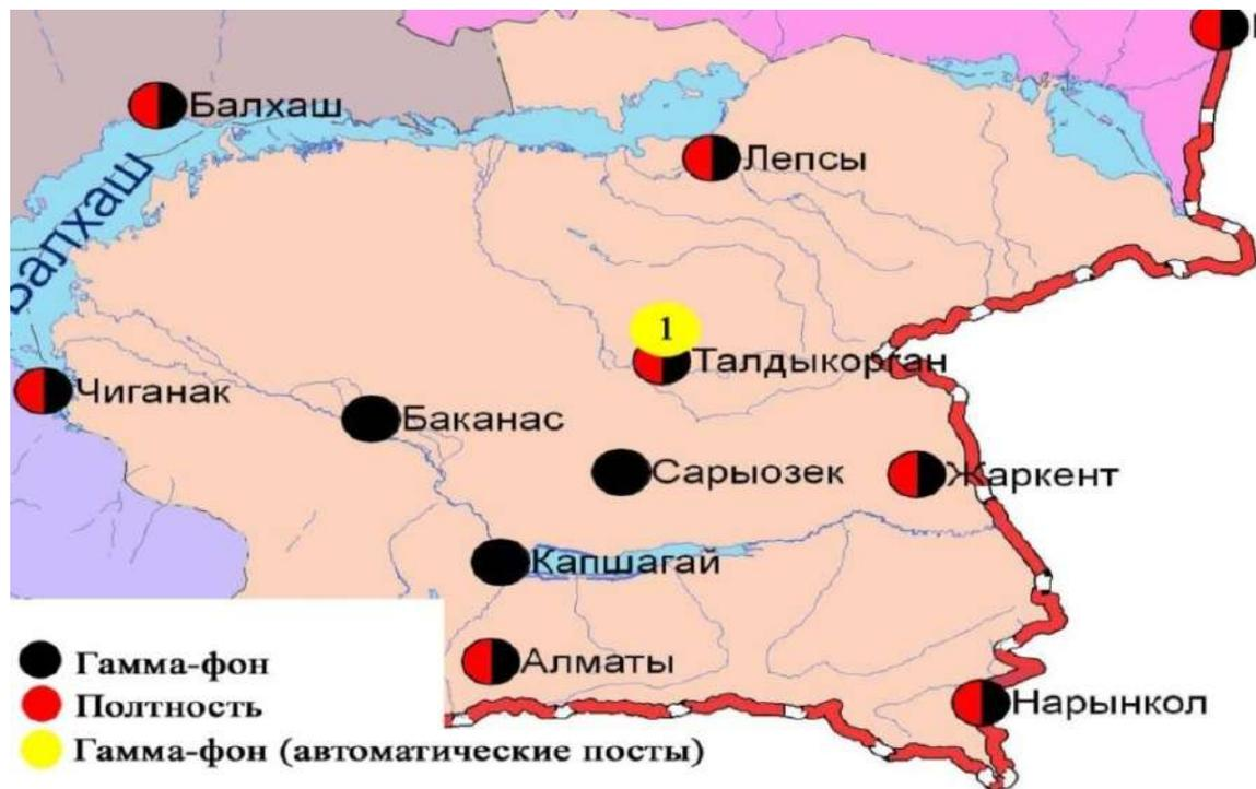
Рис. 3.2 Схема расположения метеостанций за наблюдением уровня радиационного гамма-фона и плотности радиоактивных выпадений на территории Алматинской области
