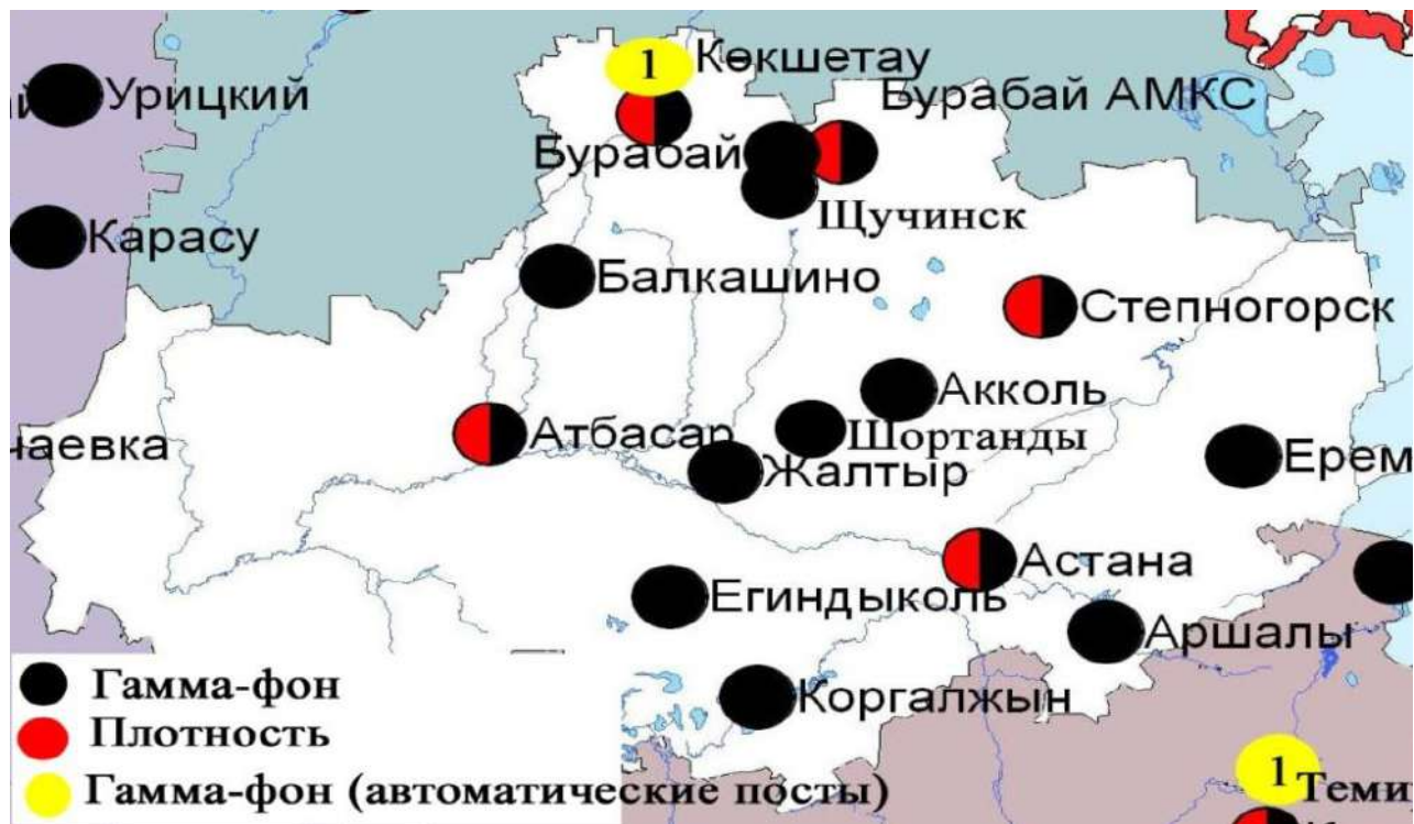
Рис. 1.6 Схема расположения метеостанций за наблюдением уровня радиационного гамма-фона и плотности радиоактивных выпадений на территории Акмолинской области
