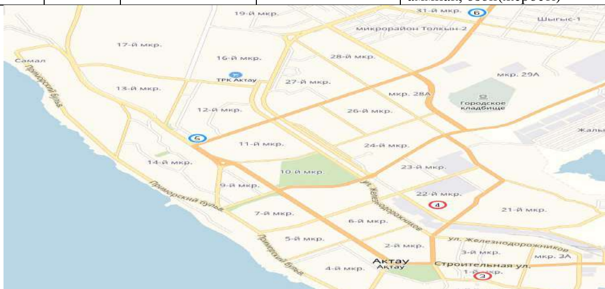
11.1 сур. Ақтау қаласының атмосфералық ауа ластануын бақылау стационарлық желісінің орналасу сызбасы
