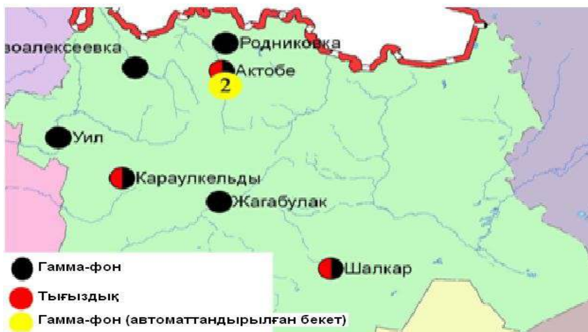
2.4 сур. Ақтобе облысының аумағындағы радиациялық гамма-фон мен радиоактивті түсулердің тығыздығын бақылау метеостансаларының орналасу сызбасы.
