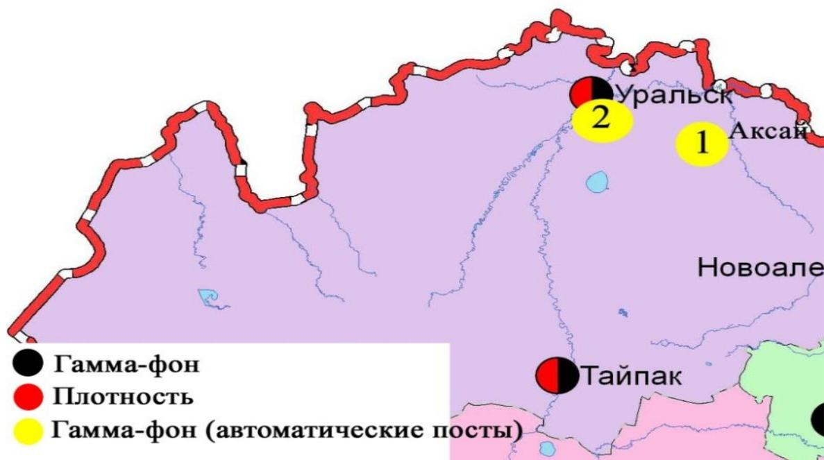
Рис. 7.4 Схема расположения метеостанций за наблюдением уровня радиационного гамма-фона и плотности радиоактивных выпадений на территории Западно-Казахстанской области
