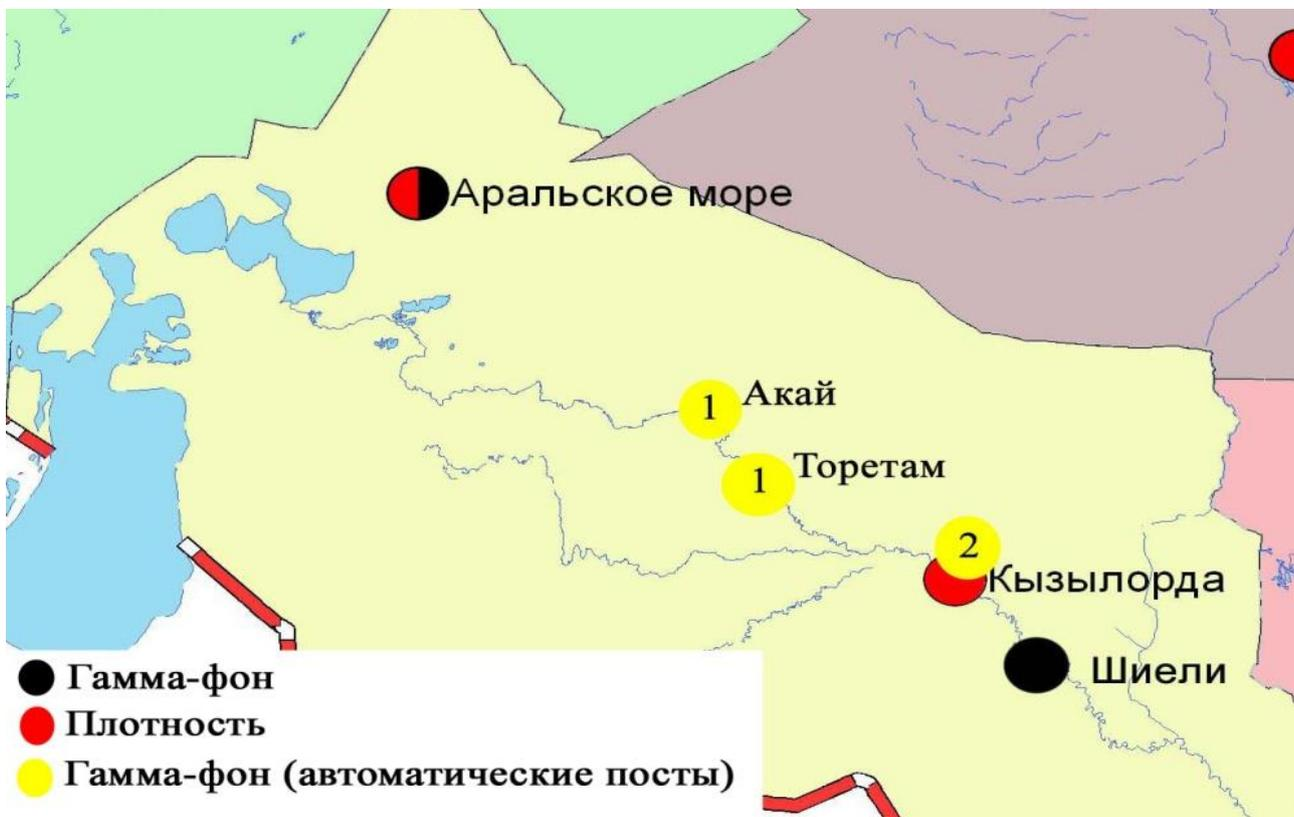
Рис. 10.4 Схема расположения метеостанций за наблюдением уровня радиационного гамма-фона и плотности радиоактивных выпадений на территории Кызылординской области
