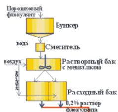
Схема приготовления раствора порошкового флокулянта
