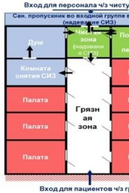
Схема модульного инфекционного стационара
