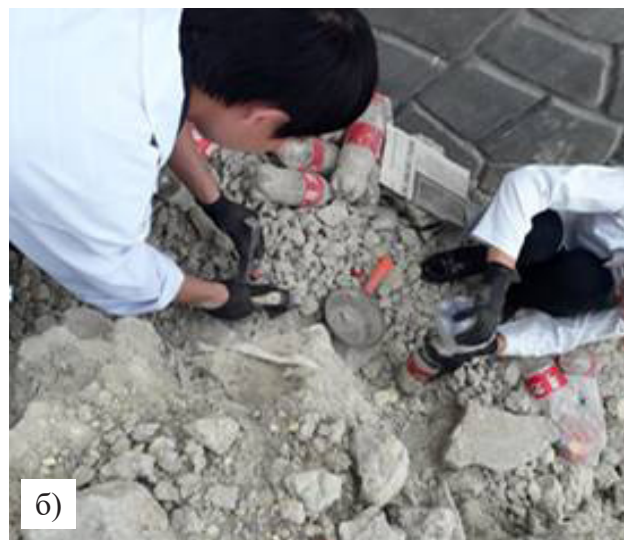
9 сурет – "СКЗ-У" өндірістік қалдықтарын ұсақтап, ПЭТ-бөтелкелерін толтыру
