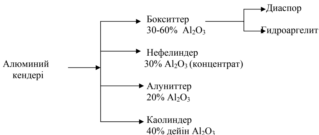
2-сурет. Алюминий өндірісінің жалпы сызбанұсқасы
