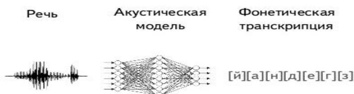
1-сурет – Сөйлеуді тану процесі. Сөйлеуді танудың техникалық сипаттамалары
