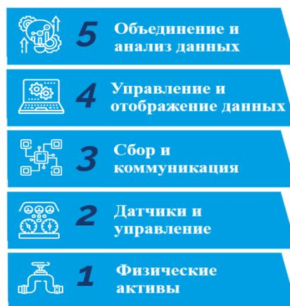
Рисунок 1 - Пятислойная модель цифрового водоканала [9]
