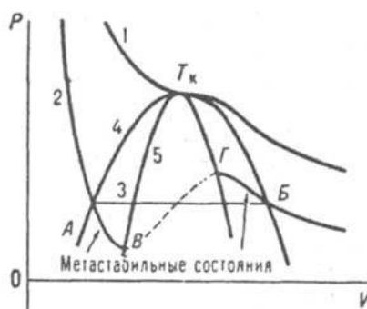
Рис. 3. Зависимости P-V при T_k (1) и меньше T_k (2): ВГ – лабильные состояния (состояния неустойчивости не только к сильным, но и к слабым возмущениям); прямая 3 соединяет равновесные состояния жидкости и пара; 4 – бинадаль; 5 – спинодаль; T_k – критическая точка. Источник: https://xumuk.ru/encyklopedia/1562.html
