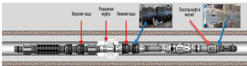
Рисунок 11. Схематическая конструкция селективного пакера
